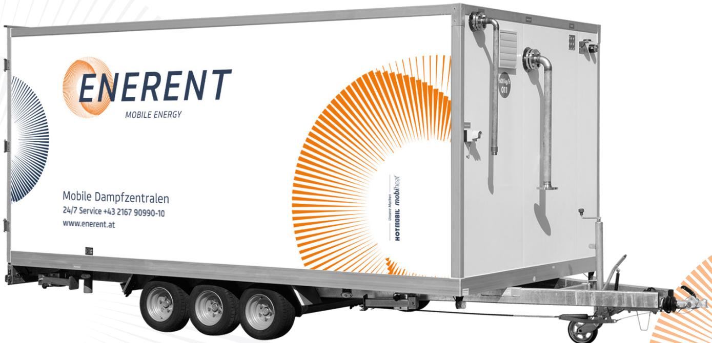
Die mobile Dampfzentrale MDZ 600 ist ein fahrbarer und sofort betriebsbereiter Schnelldampferzeuger auf einem Tandemanhänger für den mobilen Einsatz und autarken Betrieb. Die Anlage ist ausgestattet mit Wasserservicemodul, Wasseraufbereitung, Härteüberwachung, Automatikstarteinrichtung für autom. Betrieb und Außerbetriebnahme, Wasserprobekühleinrichtung und automatischer Chemikaliendosierung. Unsere mobilen Dampfzentralen sind alle nach neuestem Stand der Technik entwickelt und mit Kessel
